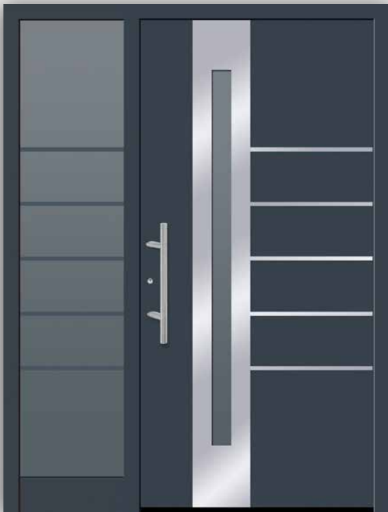
Modell KU 130 | AL 130 Edelstahlapplikationen außen, innen Glshalterahmen ○ RAL 7016 ○ Glas Satinato ○ Griff EAS 500 ○ Seitenteil ST 130, Satinato mit klaren Streifen ○ Ausführung flügelüberdeckend
